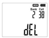
Der Fortschritt der Löschung ist auf der Anzeige in Form von wechselnden Zellennummern zu sehen, und nach der Beendigung der Löschung generiert das Gerät zwei kurze Signaltöne und stellt die Zellennummer auf 1 und die Banknummer auf 0.
