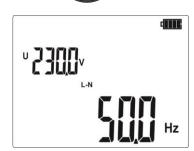
Lesen Sie das Ergebnis ab: die Spannung wird im Hilfsbereich des Displays angezeigt, die Frequenz im Hauptfeld.
